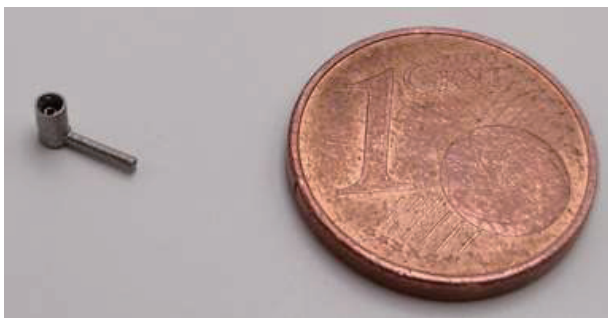
図 5：マイクロキールプローブ (D=1.6mm) 伸長していない状態
